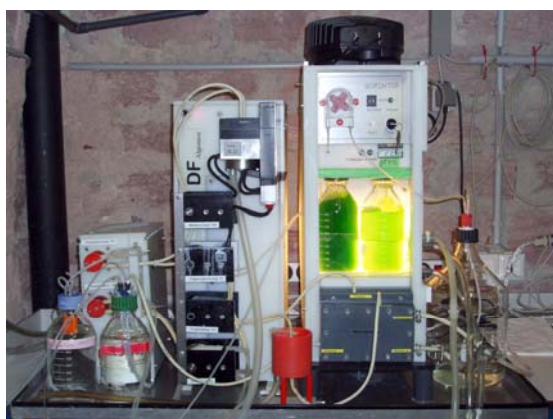
Abb. 1.3.15: Algentest an seinem Standort in der RGS. Aufstellung von links nach rechts: Add-on für den täglich durchgeführten Empfindlichkeitstest mit Atrazin, Messgerät, Algenhälterung, Flasche mit Nährmedium für die Algen
