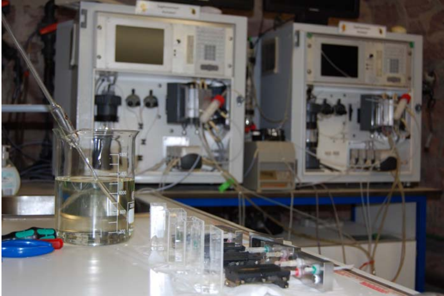
Abb. 1.3.11 Die zwei bbe-Daphnientoximeter der Rheingütestation Worms an ihrem Standort im Gewölbe mit den vier geöffneten Messkammern und einem Zuchtglas Daphnien im Vordergrund.
